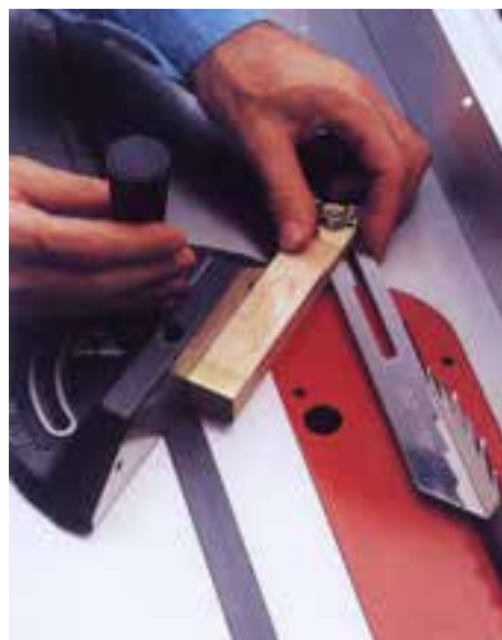
شکل ۱۲-۲۰- تنظیم زاویه‌ی تیغه
