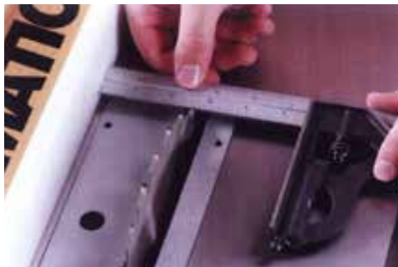
شکل ۱۲-۱۹- تنظیم فاصله‌ی تیغه تا گونیا.
