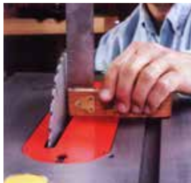
شکل ۱۲-۱۶- کنترل زاویه‌ی تیغه.
