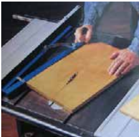
شکل ۱۲-۲۹- برش مورب با ابزار کمکی.
