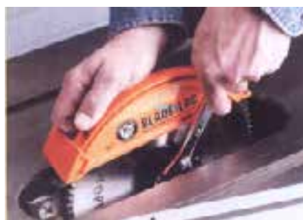
شکل ۱۲-۳۱- نمونه‌ی باز کردن تیغه؛ در صورتی که تیغه ثابت باشد.
